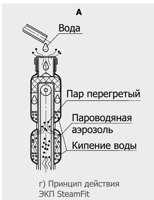
Рис. 2 Устройство электрокаменок SteamFit (СтимФит)
